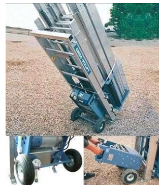
Rack de transport N° 02886 Les roues adaptables sur le treuil servent aussi au portage de l'ensemble de l'élévateur
